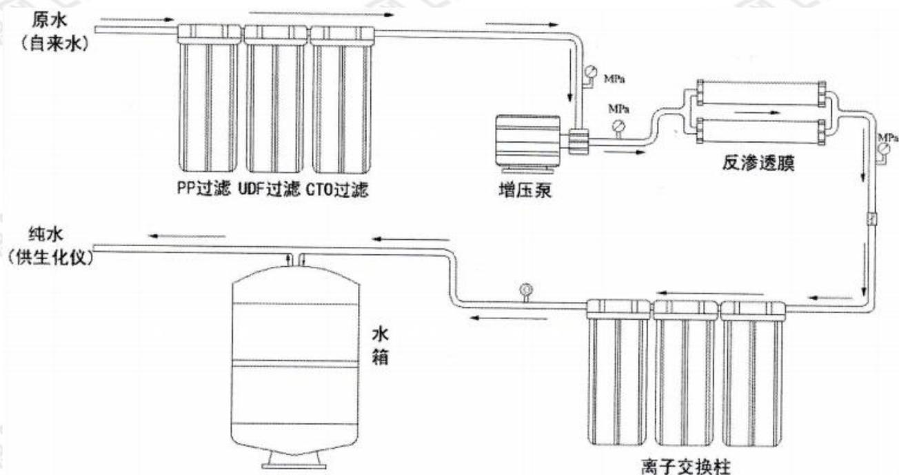
原水（自来水） → PP 棉过滤器 → UDF 碳芯过滤器 → CTO 碳芯过滤器 → 增压泵 → 反渗透膜 → 离子纯化柱 → 纯水箱 → 终端用水点
