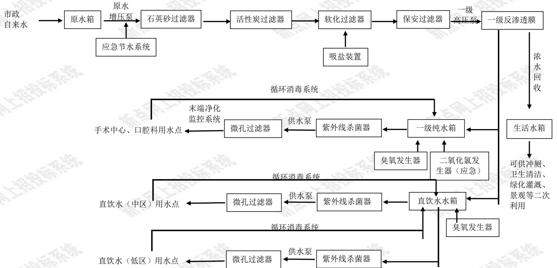
图 3-1 物联网+中央分质供水系统工艺流程图
