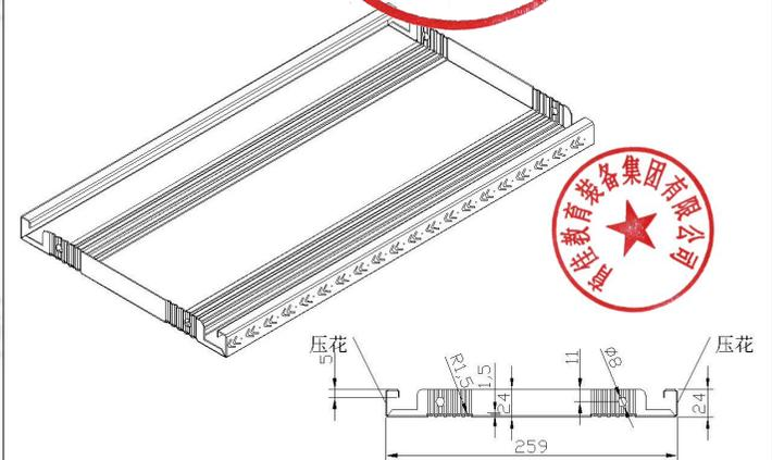
★(3)挂板: 采用 0.9mm 厚优质冷轧钢板一次滚压成型, 并带有 6 条 120mm 长的分段式圆弧凹型加
