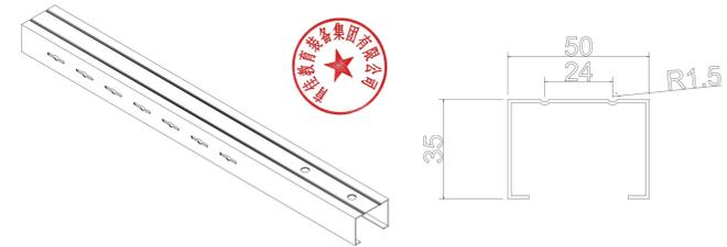
★2、层板: 层板能沿立柱垂直方向随意调整高度。采用 0.9mm 厚优质冷轧钢板(经 4 折弯)一次滚压成型, 格板承重面有 10 条 R1.5 深度 1.5mm 的内凹圆弧加强筋, 每 100mm 成型 1 条, 表面内有 1 条《图案加强》。 **我公司提供符合参数的折弯示意图并加盖生产厂家公章。**
